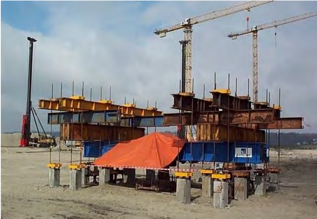
Abbildung 18: Statische Probelastung auf dem aufgespülten Baugelände Mühlenberger Loch für das Bauvorhaben „Lackierhalle Airbus“ (Quelle: Fa. Centrum Pfähle)
