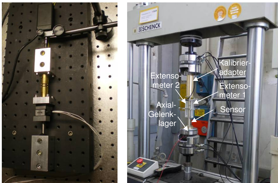
Abbildung 3: Links: Validierung der kleinmaßstäblichen Sensoren mittels Wegaufnehmer, rechts: Validierung der maßstäblichen Sensoren mittels Prüfmaschine
