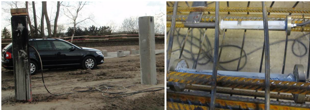
Abbildung 6: Links: Pfähle nach dem Rammen, rechts: Messebene mit EFPI-Sensor (oberer Sensor) und Vergleichssensor (unterer Sensor).
